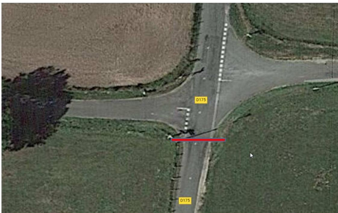
Passage de 3 fourreaux PVC 42/45 en tranchée en traversée de chaussée RD175
