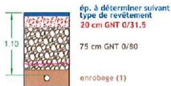
sous accotement stabilisé
